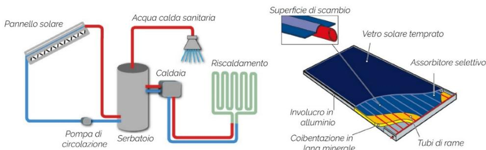
Impianto solare termico, per riscaldamento degli ambienti e per acqua calda sanitaria (la EVA serve solo al riscaldamento ACS)
