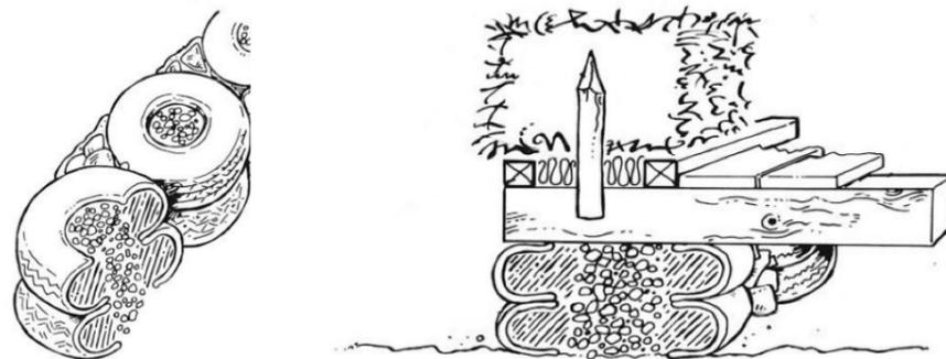
Schema diagrammatico del posizionamento degli pneumatici e dell'aggrappo con la paglia
